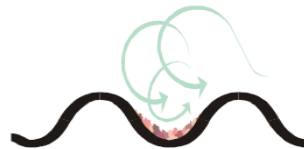
Abbildung 2. Darstellung, wie die turbulente Strömung und die Scherspannungen dabei helfen, den Übertrager sauber zu halten.
