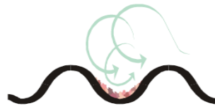
Imagen 2. Una ilustración de cómo el flujo turbulento y las tensiones de cizallamiento ayudan a mantener el BPHE limpio.
