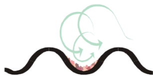
Figure 2. Une illustration de la façon dont le flux turbulent et les contraintes de cisaillement permettent de garder le BPHE propre.
