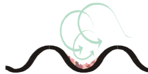
Figure 2. Une illustration de la façon dont la turbulence et les tensions de cisaillement ou forces contribuent à nettoyer le BPHE.
