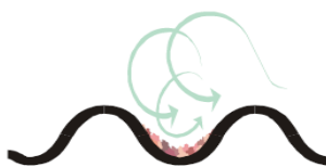
Figura 2. Uma ilustração de como o fluxo turbulento e as tensões de cisalhamento ajudam a manter o BPHE limpo.
