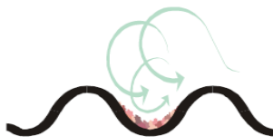
Figura 2. Uma ilustração de como o fluxo turbulento e as tensões de cisalhamento ajudam a manter os trocadores de calor de placas brasadas (BPHEs) limpo.
